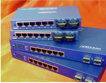
La necesidad de gestionar los diagramas proyectados en todas sus formas "estrella", "cascadas" o "cuasi anillos" ahora pueden ser resueltos con los mini switches Adecomm con administración Web. Siempre con 2 puertos ópticos y 6 de cobre, en versiones de **10/100** ó en **Gigabite** resuelven en un protocolo amigable la llegada de los más variados servicios.
