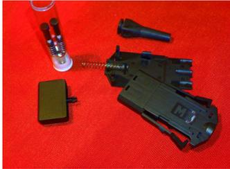
El ESCON fué desarrollado por IBM, posee dos (2) férulas de 2.55mm y su característico diseño a tarjeta deriva de la aplicación inicial para los sistemas de computación IBM, utilizado en estructura de redes que soportan hasta 200Mbps. es de tipo full dúplex por defecto y sus dos férulas son cerámicas y el armado de los patch-cords de tpo "cruzados". IL: <-0.5 db.
