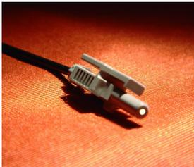
Siguiendo con la línea de conectores para fibra plástica donde la interfaz de datos no es una fuente láser, Adecomm ensambla esta línea de conectores compatible con el diseño de HP, los mismos vienen en color Azul o Gris y en versión "Simple" o "Latching Simple". Son montados son cables de fibra óptica plástica de 1mm. de diámetro, son pulidos hasta la mínima e imperceptible rugosidad.
